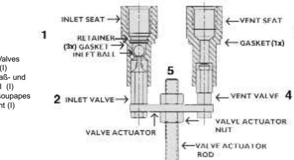
Cambio de válvulas motor y de viento (I)
